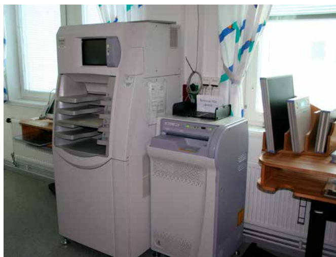
Fujifilm digital kassettläsare där fyra kassetter av olika format samtidigt kunde hanteras. Sahlgrenska, Göteborg. 2005, foto Mats Geijer.
