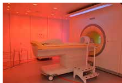
Fig 4. 7T-utrustningen efter avslutad installation. Magneterna är aktivt skärmade, vilket innebär att strömfältet från kameran begränsas i utsträckning så att denna typ av andra generationens 7T-kameror blir mindre utrymmekrävande än sina föregångare, och därmed på ett enklare sätt kan placeras i sjukhusmiljö.
